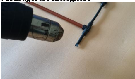
10.A végek szigetelése
